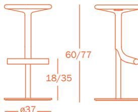
adjustable in height/ altura regulable/ réglable en hauteur/ drehbar/ regolabile in altezza
